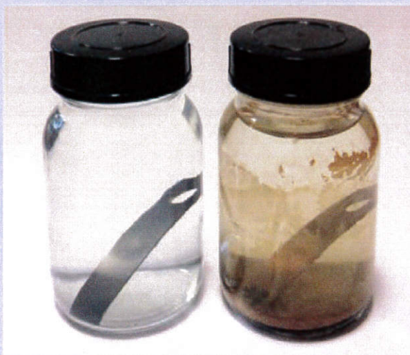
Aqua-Concept: Korrosionstest mit und einmal ohne coracon® VE 9.
