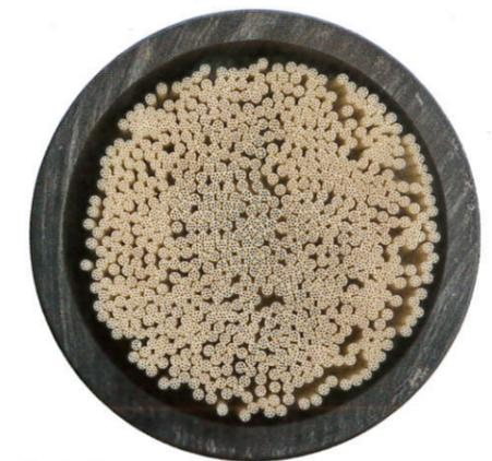
Membrantest. Er überprüft die Filter im vorgegebenen Zeitintervall vollautomatisch im laufenden Betrieb. Selbst kleinste Schäden an der Filtermembran sind so erkennbar und können sofort behoben werden.
